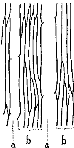
Fig. 93a. — Langwerpige snede in het hout. a Vaten. — b Houtvezels.
